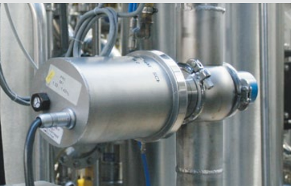
90° Winkel VariVent-Flansch mit Schlauchverbindung Rohrleitung VariVent mit Ultraschall-Reinigungseinheit
